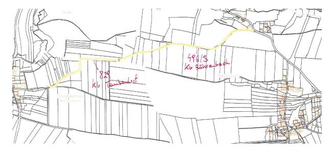
Der Germannserweg GSN 1026 und 1027 KG Tautendorf soll mittel 2-maliger vollflächiger Aufbringung von Bitumen saniert werden.
